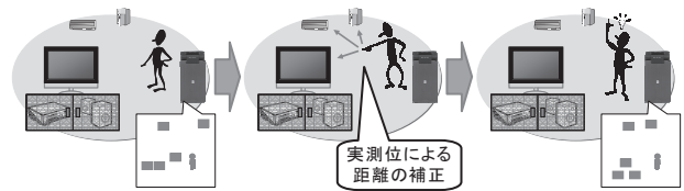
図 3 実測位による距離の補正を利用した位置推定
